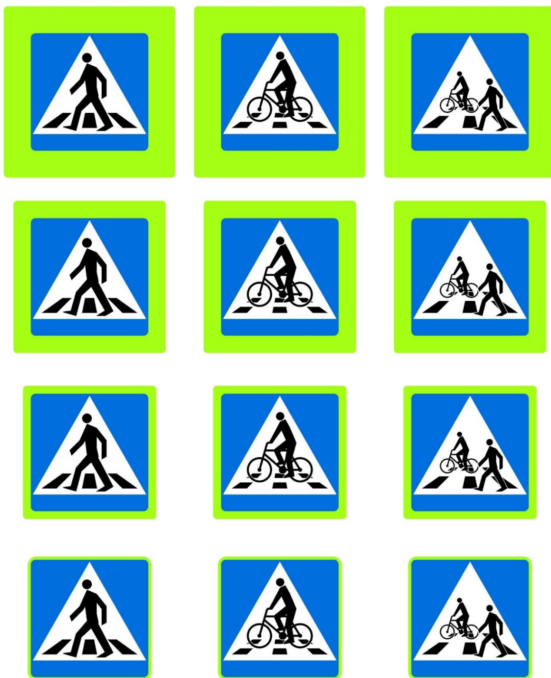
Rys.5.8.3. Oznakowanie z tłem fluorescencyjnym o różnej szerokości obwiedni
