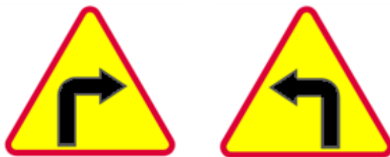
Rys. 5.2.2.1. Znak ostrzegawczy „szczególnie niebezpieczny zakręt”, w prawo (A-101d), w lewo (A-101e).
